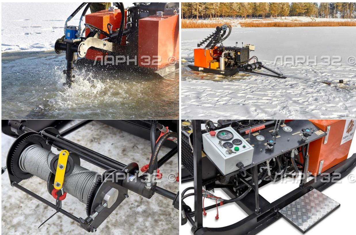
Главное отличие фрезерной установки «ЛУ» от цепных установок, заключается в применении **фрезерного** рабочего органа. При работе фрезы в штробе не остаются блоки льда, а значит не требуются затраты для их последующего извлечения.
