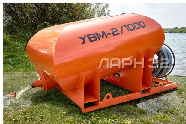
**Универсальность установки УВМ-2** состоит в способности сбора жидкостей любого типа и их разгрузки без применения дополнительного насосного оборудования. Сбор и разгрузка собранной жидкости осуществляется с помощью одного рукава. Оснащение установки УВМ-2 удобными органами управления позволяет плавно регулировать и переключать режимы работы «сбор-нейтраль-разгрузка».
