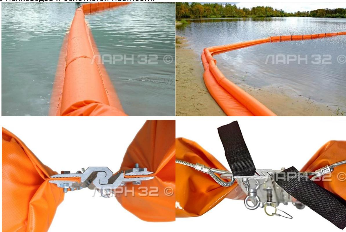
Секции **бона берегозащитного** состоят из трех камер, из которых две нижние камеры водонаполняемые, а верхняя камера наполняется воздухом. Секции **бона БНбз** оснащены **S-образными замками ASTM** для соединения секций в цепь, а так же для соединения с бонами другого типа, например бонами заградительными БНп. По желанию заказчика могут быть установлены **Z-образные замки ASTM**.
