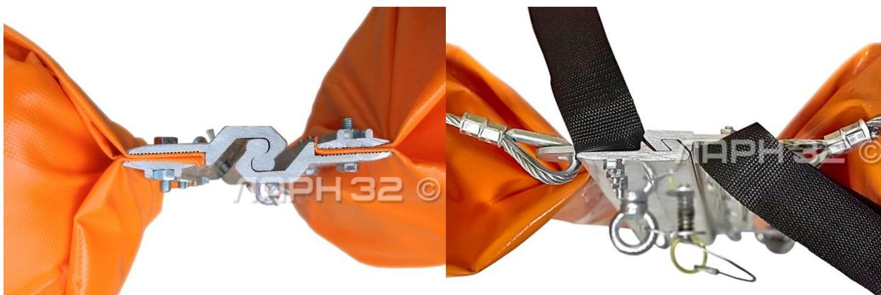
Секция **бона БНбп** состоит из пяти частей оснащенных элементами плавучести, плоская форма которых обеспечивает компактность бона в транспортном положении. Части секции бона соединяются между собой гибким элементом. Гибкое соединение секций обеспечивает подвижность бона в вертикальной и горизонтальной плоскости, что позволяет бону более точно следовать рельефу.
