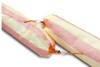
3. **Боны сорбирующие усиленные** - отличаются наличием силового элемента, проходящего сквозь бон, и карабинами - для быстрого и надежного соединения бонов в цепь. Специальная конструкция позволяет соединять боны с перекрытием, что полностью предотвращает протекание нефтепродукта.
