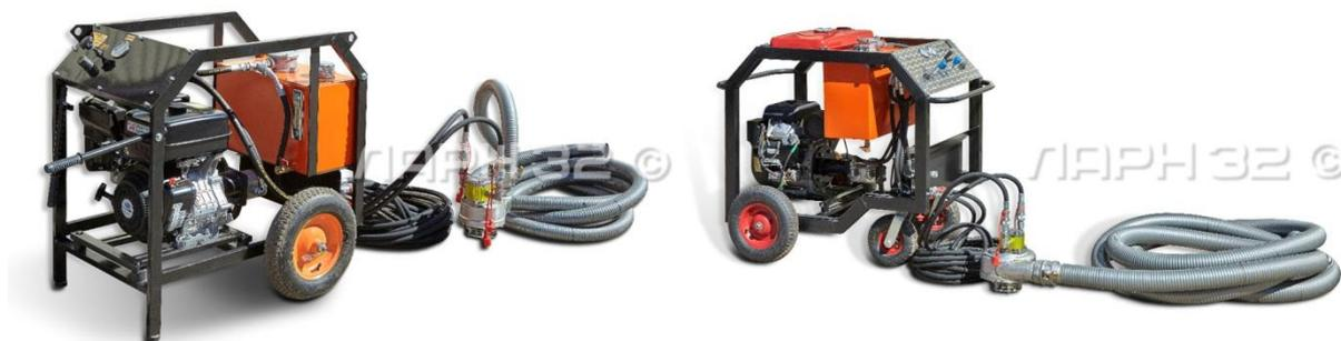
Станции «ПС-ОГ» способны перекачивать загрязненную воду, жидкие нефть и нефтепродукты с малым содержанием мехпримесей и используются для откачки жидкостей из котлованов, колодцев, отстойников, резервуаров и в труднодоступных местах.
