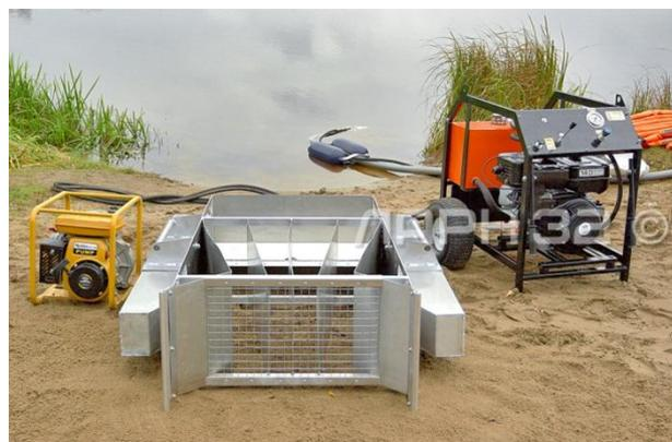
**Нефтесборщик ПН-2** имеет регулируемые поплавки и волноуспокоители, обладает малым весом, оснащен удобными ручками для перемещения в район ЛАРН всего двумя специалистами. Конструкция ПН-2 выполнена из искробезопасного алюминиевого сплава, оснащена волноуспокоителями позволяющими работать на течении и волнах, которые снижают колебания уровня перед порогом, что сокращает долю захватываемой с нефтепродуктом воды.
