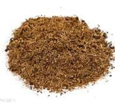
Сорбент "БиоНьюсорб" применяется для ликвидации разливов сырой нефти и нефтепродуктов с последующим их биоразложением на водной и твердой поверхности.
