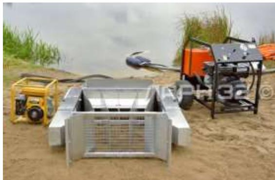
Нефтесборщик ПН-2 имеет регулируемые поплавки и волноуспокоители, обладает малым весом, оснащен удобными ручками для перемещения в район ЛАРН всего двумя специалистами.
