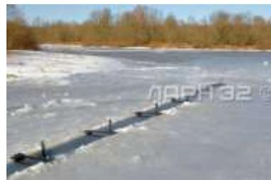
Бон заградительный зимний «БНз» предназначен для локализации разливов нефти и нефтепродуктов подо льдом на водоемах с течением. Бон зимний способен эффективно улавливать и подводить нефть к местам накопления для последующего сбора разлива нефтесборными устройствами.
