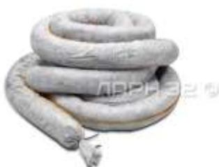
**Минибоны сорбирующие** отличаются небольшим диаметром и простотой конструкции. Минибон представляет собой рукав из спанбонда, наполненный гидрофобным наполнителем. На краях минибона есть завязки для соединения бонов друг с другом.
