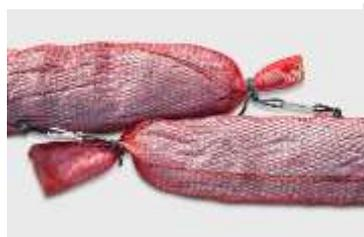
**Боны сорбирующие усиленные** отличаются от сорбирующих бонов внешней оболочкой из прочной полимерной сетки, наличием силового элемента - каната, проходящего вдоль бона и карабинами для быстрого и надежного соединения бонов в цепь. Специальная конструкция позволяет соединять боны с перекрытием, что полностью предотвращает протекание нефтепродукта в местах соединений сорбирующих бонов.
