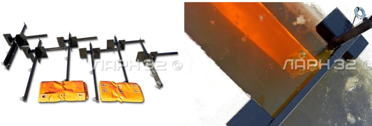
**Бон заградительный зимний «БНз»** предназначен для локализации разливов нефти и нефтепродуктов подо льдом на водоемах с течением. Бон зимний способен эффективно улавливать и подводить нефть к местам накопления для последующего сбора разлива нефтесборными устройствами.
