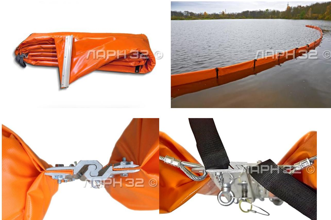
**Боны заградительные БНп** представляют собой 10-ти метровые секции, выполненные из ткани ПВХ сигнального цвета, устойчивой к агрессивному воздействию окружающей среды, заполненные мягкими плоскими поплавками. Боны имеют верхний силовой элемент и нижний, одновременно выполняющий роль балласта.
